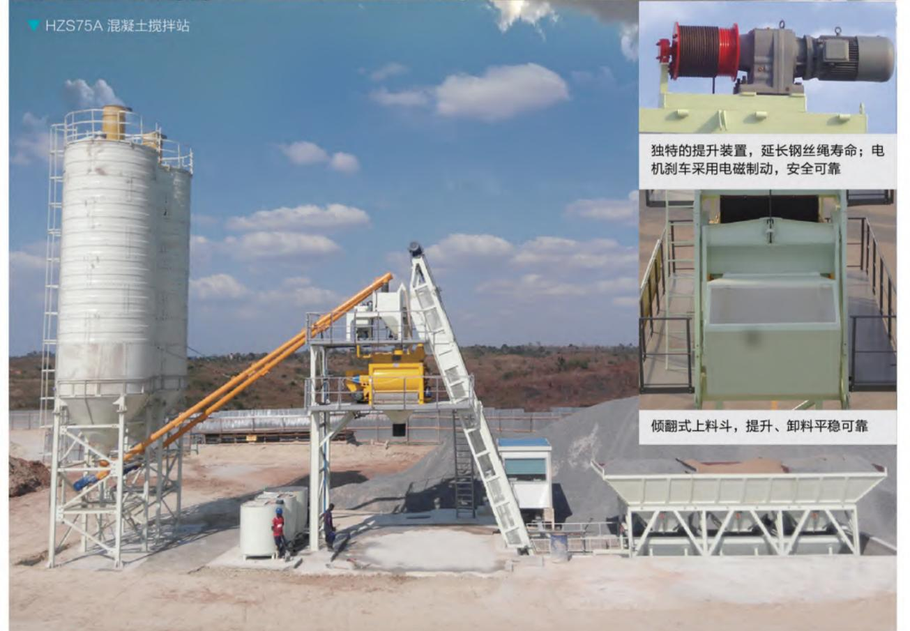
独特的提升装置，延长钢丝绳寿命；电机刹车采用电磁制动，安全可靠
