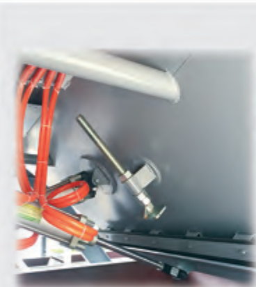
增加开度调节装置，调节不同物料卸料速度
