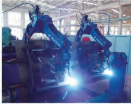
▲ 标准节框架焊接机器人
