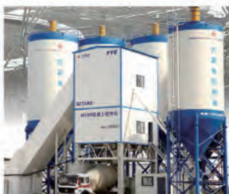
国内首台核电站建设专用混凝土搅拌站
