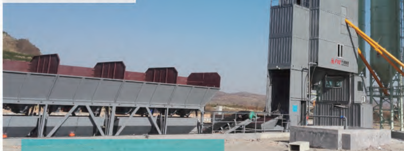
模块化箱体式设计，主站安装仅需3小时。
