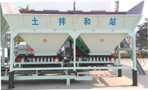
▲ 超大方量骨料斗设计，有效减轻装载机上料压力
