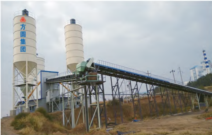
▲ 用于内蒙古赤峰元宝山区古镇第一煤矿的LWBZ500连续式矿用回填设备
