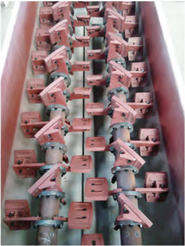
▲ 搅拌叶片、搅拌臂由特殊耐磨材料制成，使用寿命长
